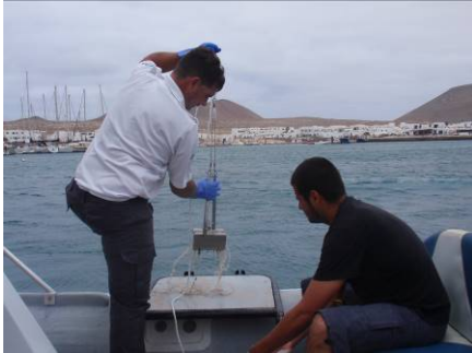
FIGURA 4. Toma de muestras arenosas submareales con la draga Van Veen frente al puerto de Caleta de Sebo.
